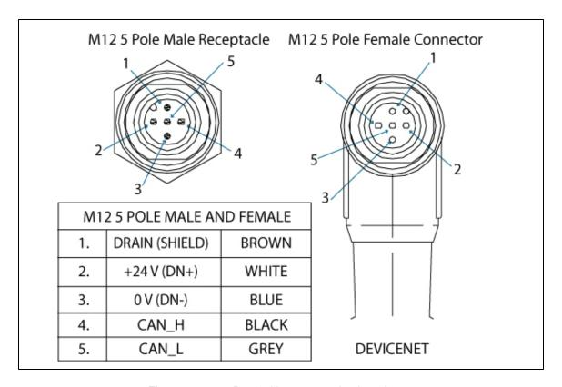
Figure 3.4.2.1 : DeviceNet communication pinout.
