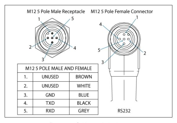
Figure 3.4.2.5 : Serial communication pin-out.
