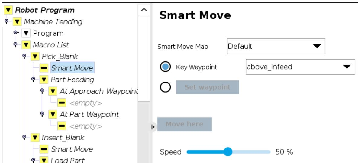
Fig. 4-22: **Pick\_Blank** macro - **Smart Move**
